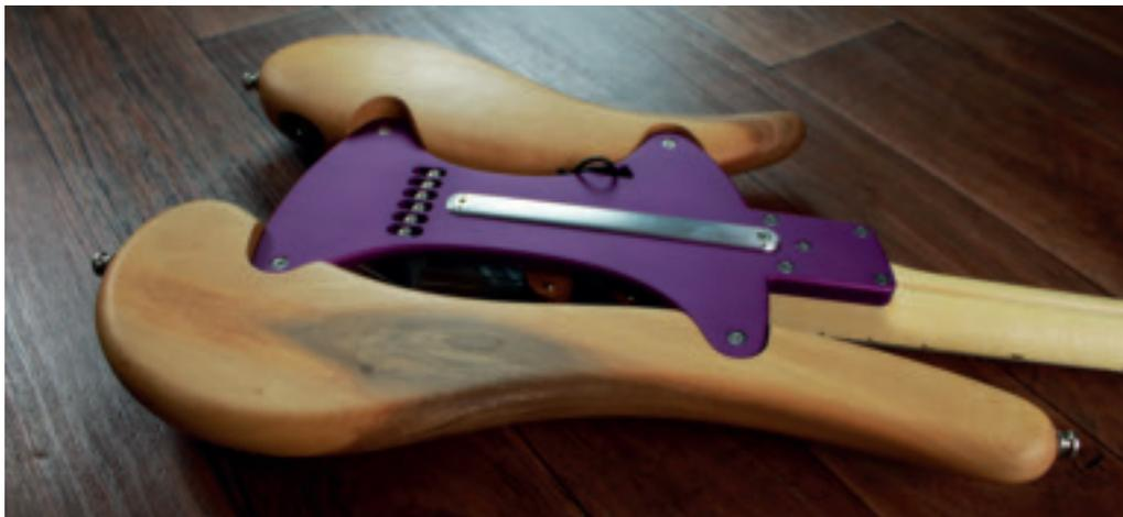
wenngleich auf den ersten Blick nicht abschätzbar ist, wie sich die grundlegende Aluminium-Konstruktion der gerade einmal 3,25 Kilos schweren Gitarre klanglich bemerkbar machen wird.
